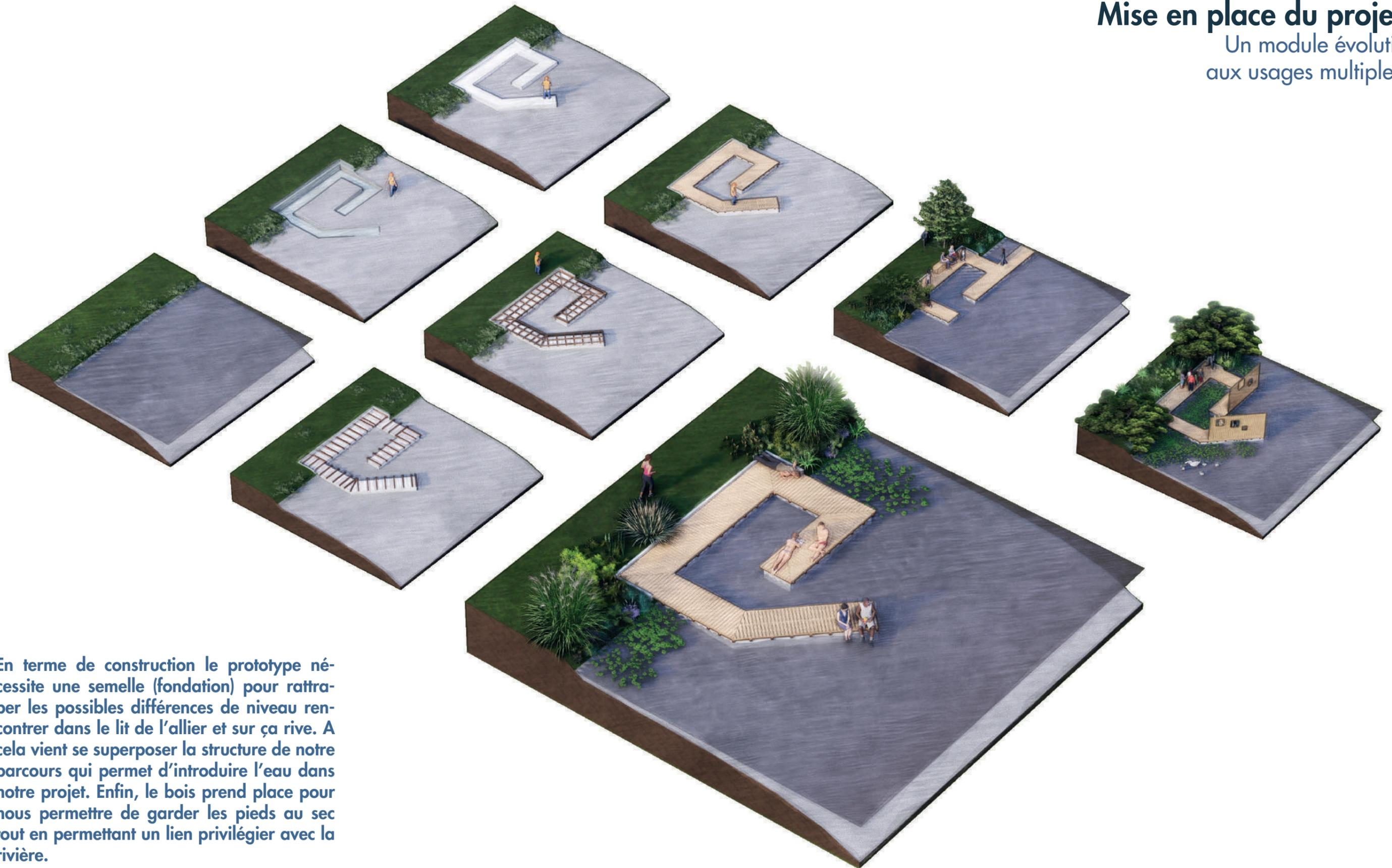
En terme de construction le prototype nécessite une semelle (fondation) pour rattraper les possibles différences de niveau rencontrées dans le lit de l'allier et sur la rive. A cela vient se superposer la structure de notre parcours qui permet d'introduire l'eau dans notre projet. Enfin, le bois prend place pour nous permettre de garder les pieds au sec tout en permettant un lien privilégié avec la rivière.
